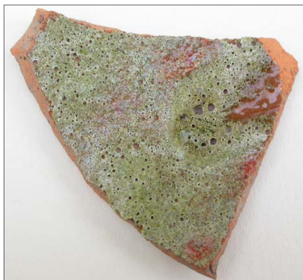
Figur 19. Skärva där glaseringen misslyckats och glasyren är fylld med blåsor. Foto Marie Ohlsén, ÖLM.
