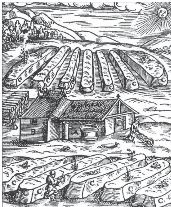
Figur 5. Träsnitt av Lazarus Ercker 1580 som visar ett salpeterbruk med bäddar av salpeterjord runt om (Ur Brown 1998).
