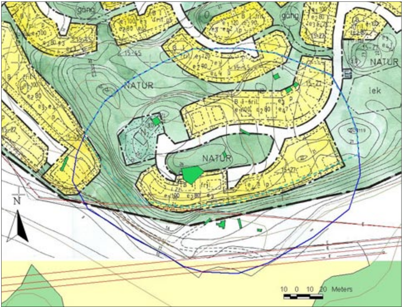
Fig 7. Schaktplan med schakt och anläggningar samt fastighetskartan med planerad bebyggelse. Gräns för förundersökningsområdet heldragen linje, ny gräns för fornlämning RAÄ 136 streckad linje. Skala 1:2000.
